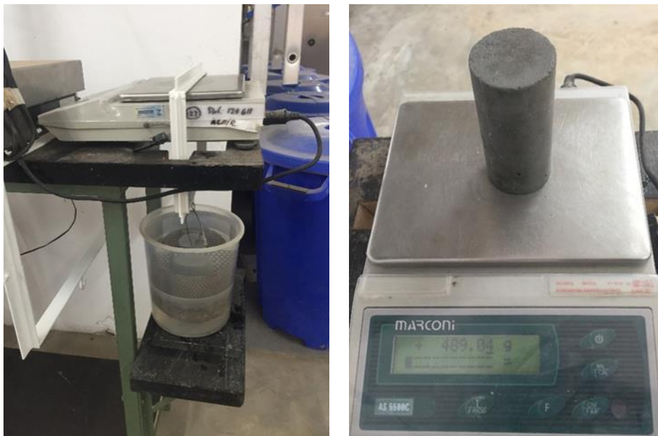
Figura 18: Etapas de pesagem do ensaio de massa específica
