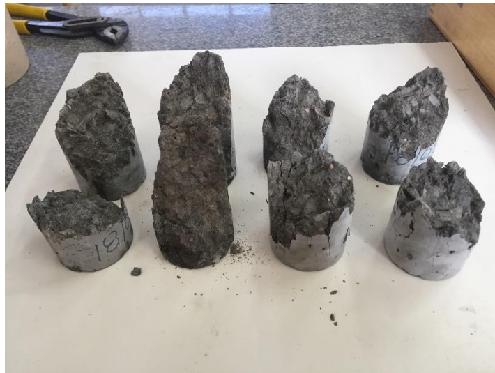
Figura 22: Formas de ruptura dos corpos de prova
