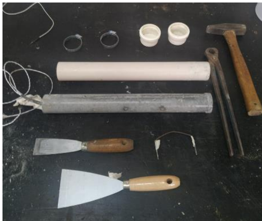
Figura 17: Corpo de prova desmoldado e equipamentos utilizados
