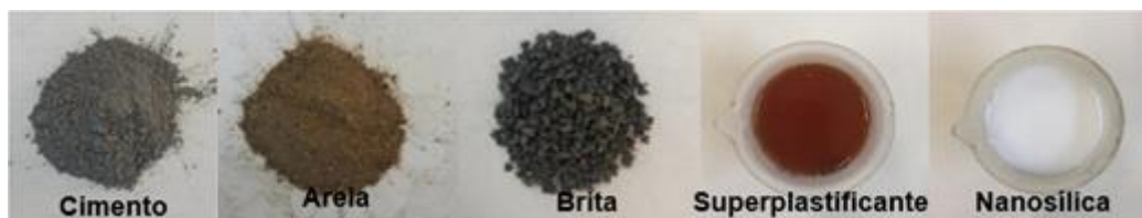
Figura 10: Materiais que serão utilizados na confecção dos concretos
