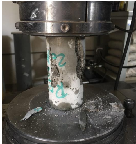
Figura 19: Corpo de prova na prensa após ruptura
