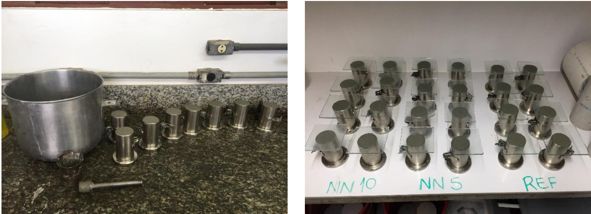
Figura 12: Processo de moldagem e corpos de prova para os ensaios de massa específica e índice de vazios e de resistência à compressão
