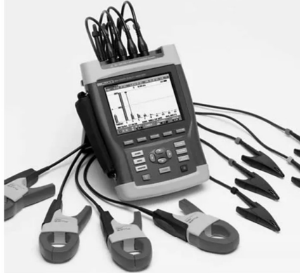
FLUKE 435 com conexão de alças e pinças
