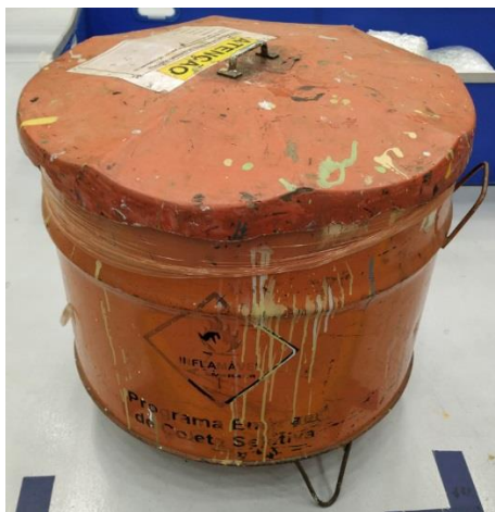
Figura 6: Tambor para resíduos sólidos perigosos.
