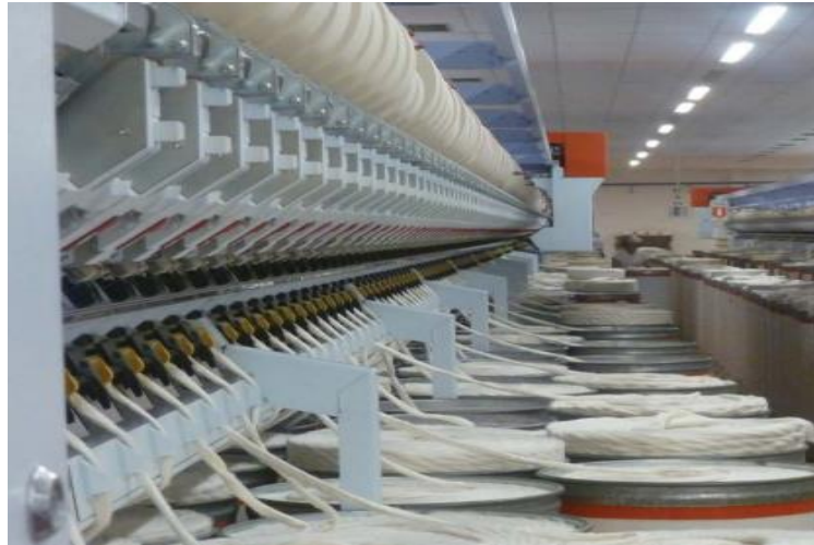
Figura 5 – Processo de estiragem
