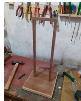
Montagem das colunas na base. Após esse passo, é recomendado passar uma camada de verniz de madeira.
