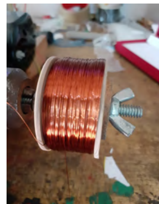
A bobina consiste de 2200 espiras de fio esmaltado bitola AWG32, cerca de 79,8g.
