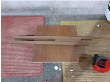
Madeira usada : 2 x peças de 1,5x15x40 1 peça de 1,5x1,5x13, 1 peça de 2,5x20x23
