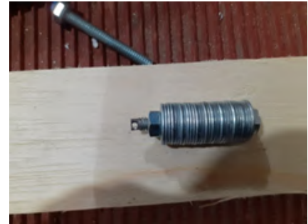
Coloque 30 arruelas de ¼" e aperte com uma porca. Essa será a massa onde o imã ficará fixo.
