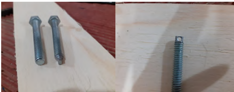
Parafuso sextavado de 2½ x ¼". Lixe a ponta para ficar abaixo da rosca e a deixe retangular. Faça um furo de 2,5 mm.
