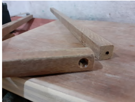
Furo com chanfro para encaixar o parafuso.
