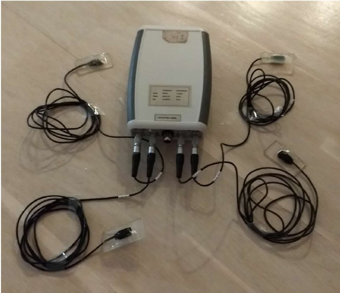
Figura 3. Inclínômetros e unidade de aquisição dos dados (Logger Teknologi HB, Åkarp, Suécia).
