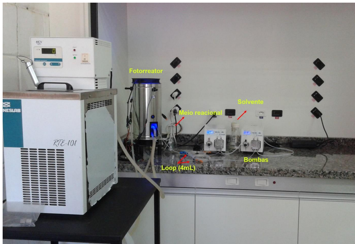
FIGURA 1.16 - Setup final para a fotoarilação em fluxo contínuo com geração do sal in situ
