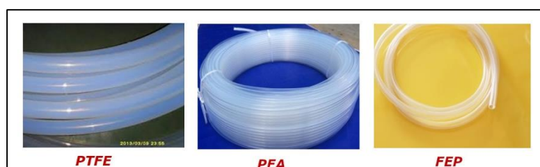
FIGURA 1.5 - Fotos dos principais matérias utilizados para construção dos reatores tubulares
