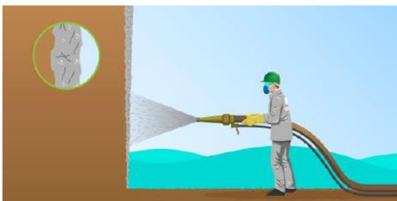
Figura 7 - Concreto projetado com fibras
