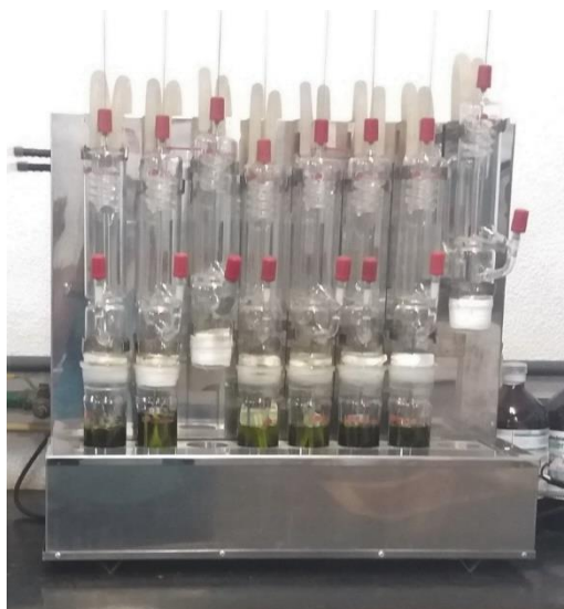
Figura 3. Soxhlet utilizado para extração dos óleos dos tratamentos trabalhados com as amostras submersas no solvente.
