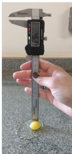
Figura 1. Mensuração da altura de albúmen com paquímetro digital.
