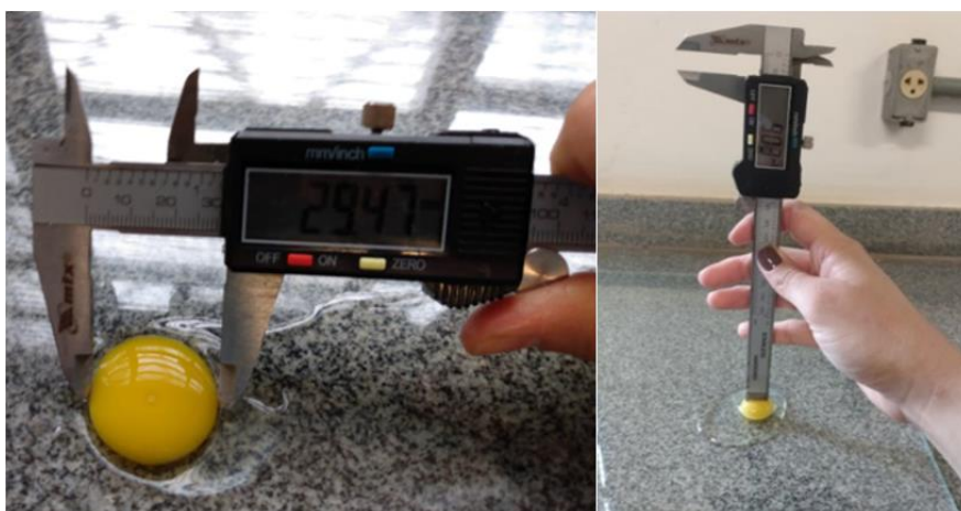
Figura 2. Mensuração do diâmetro (A) e altura da gema (B), com paquímetro digital.
