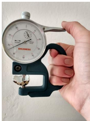
Figura 4. Mensuração da espessura da casca do ovo com micrômetro. Fonte: arquivo pessoal.
