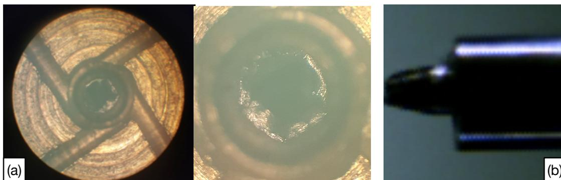
Figura 4.4 – (a) microcanais da parte do núcleo do dispositivo S2N1 com detalhes do amassamento da ponta da agulha provocado pelo processo mecânico de afunilamento; (b) cone existente na agulha para facilitar o fluxo de ar sobre a solução polimérica.
