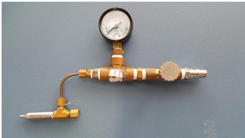
Figura 3.1 – Dispositivo coaxial para a produção de fibras poliméricas com entrada de ar comprimido na posição lateral. Tubo externo com geometria afunilada na saída do ar comprimido para aumentar a velocidade do ar e a turbulência.
