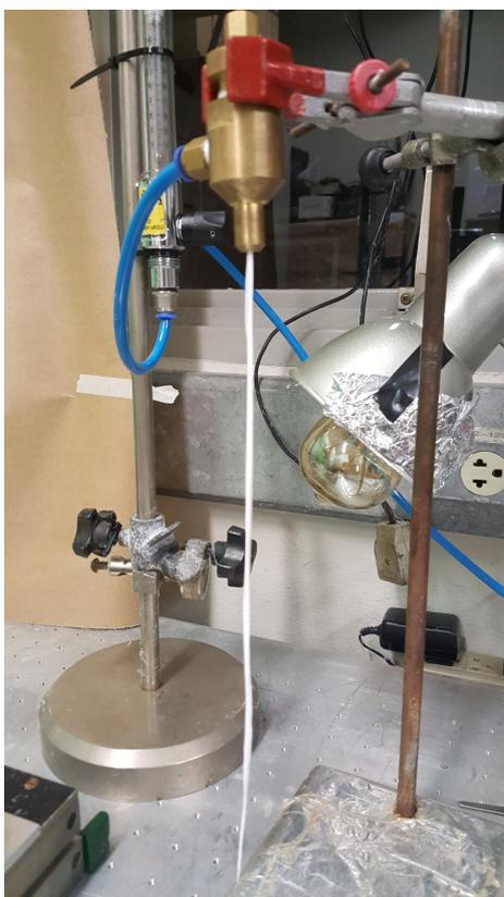
Figura 3.5 – Aparato para mostrar o comportamento do fluxo de ar rotacional sobre um cordão de algodão a uma pressão de 60 Psi.
