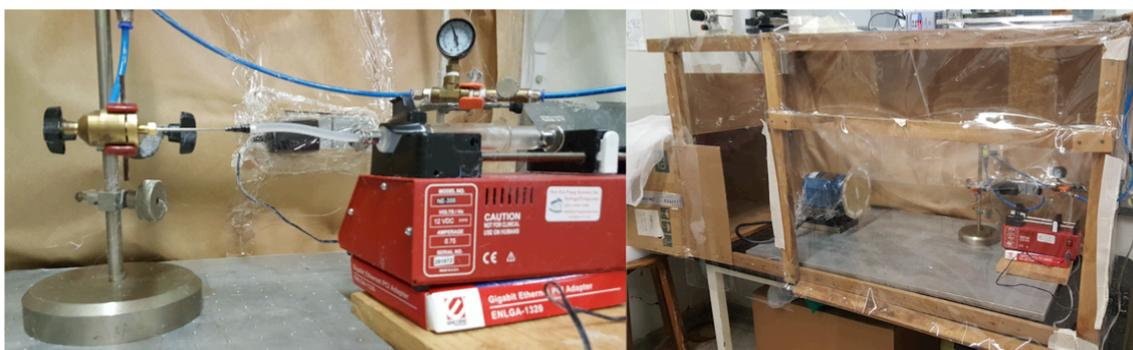
Figura 3.7 – Imagem da estrutura física fechada com fluxo de ar unidirecional para a fabricação de nanofibras.
