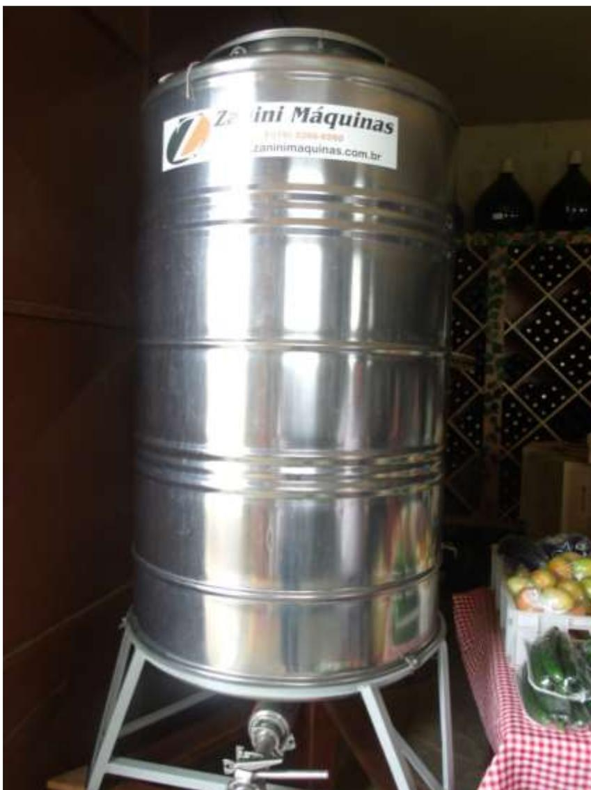
Foto 7. Equipamento utilizado para filtrar o vinho
