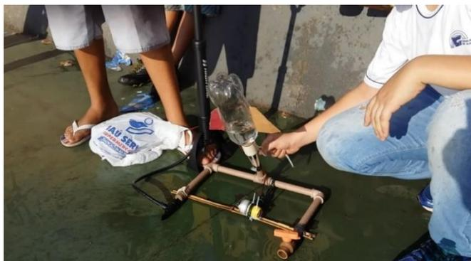
Figura 9 - Lançador de foguete feito com canos PVC
