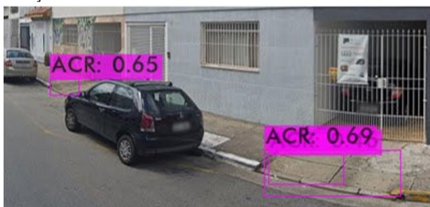
(d) Rampa para acesso de veículos e detecção sobreposta
