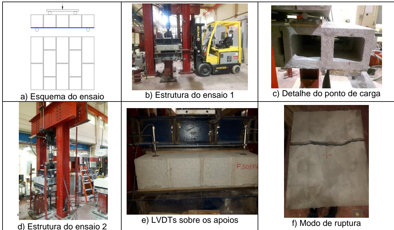
Figura 60 – Detalhes dos ensaios de resistência à flexão e ruptura.
