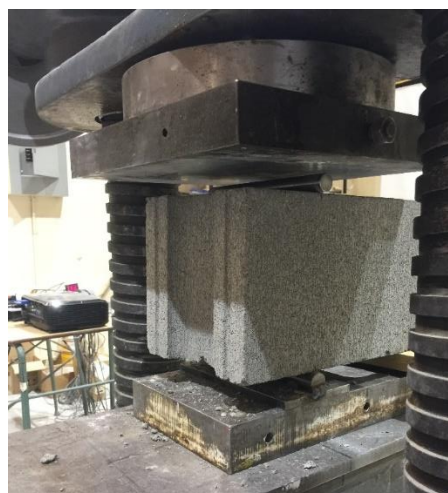
Figura 37 – Ensaio de resistência à tração indireta do bloco de concreto.
