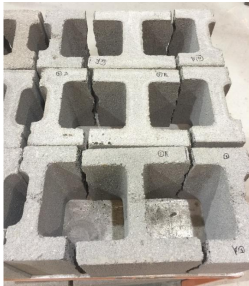
Figura 38 – Modo de ruptura padrão para ensaio de resistência à tração indireta dos blocos.
