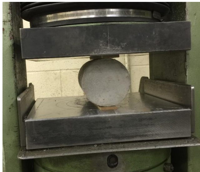
Figura 28 – Detalhe do ensaio de resistência à tração do EDCC.
