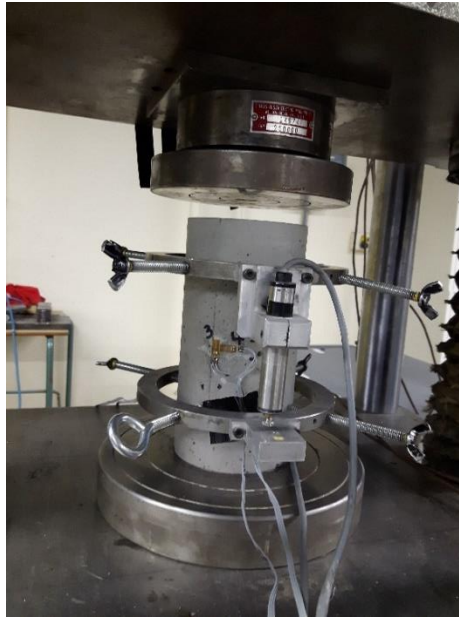
Figura 27 – Detalhes do ensaio de resistência à compressão do EDCC.
