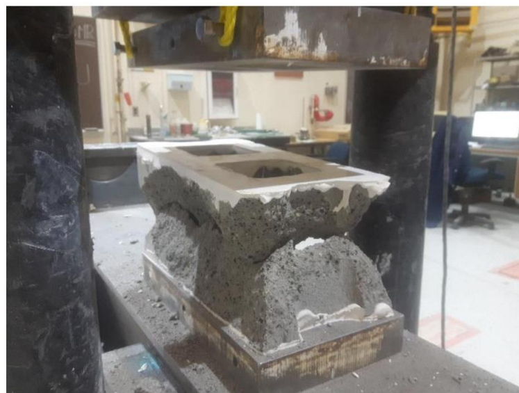
Figura 36 – Modo de ruptura do bloco de concreto.
