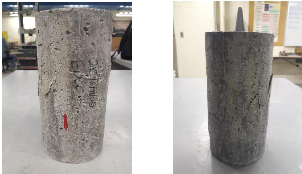
Figura 30 – Modo de ruptura dos corpos de prova de EDCC submetidos à compressão.
