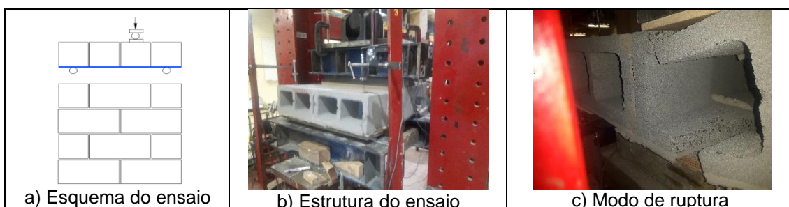
Figura 72 – Detalhes do ensaio de resistência ao cisalhamento e modo de ruptura.
