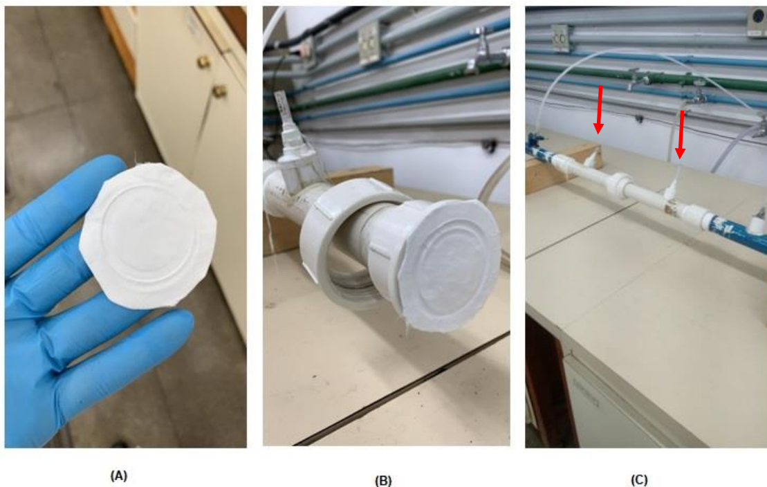
Figura 23. Dispositivo de filtração: (A) meio filtrante com área de 5,2 cm 2 , (B) área de filtração e (C) dispositivo encaixado na linha de nanopartículas.
