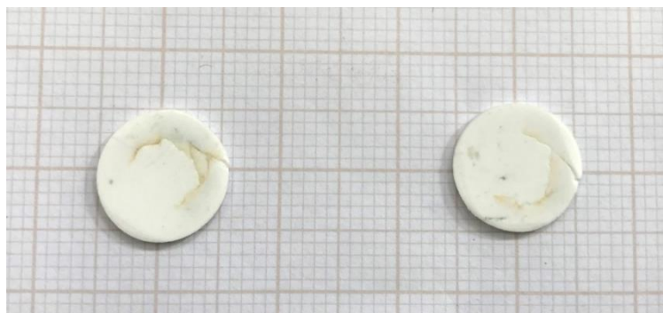
Figura 4.6 - Imagem das pastilhas de vidro prensadas, sinterizadas e cristalizadas. Para efeito de escala, o plano de fundo é um papel milimetrado, onde os menores quadrados têm dimensões 1x1 mm.
