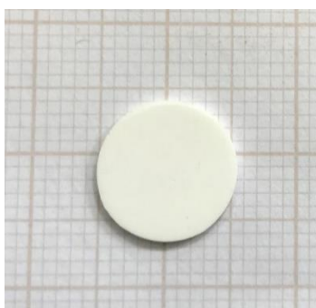
Figura 4.7 - Imagem da pastilha de vidro prensada com aditivo de sinterização, sinterizada e cristalizada. Para efeito de escala, o plano de fundo é um papel milimetrado, onde os menores quadrados têm dimensões 1x1 mm.
