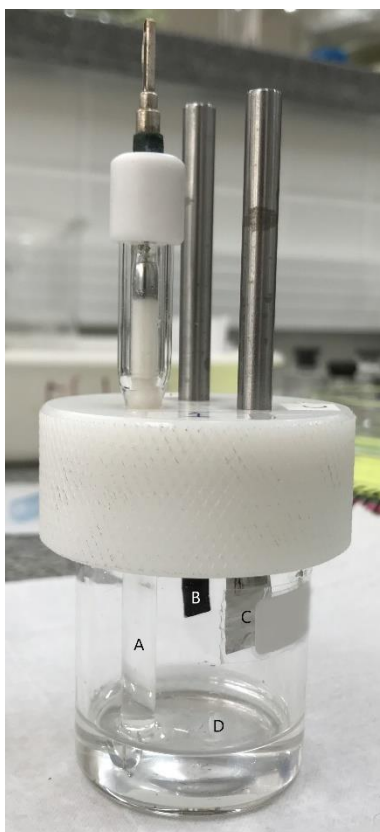
Figura 3.1 - Imagem da célula eletroquímica utilizada no ensaio de voltametria cíclica com eletrólito líquido. Eletrodo de referência: eletrodo de calomelano saturado - A; eletrodo de trabalho - B; contra eletrodo de platina - C; eletrólito líquido - D.
