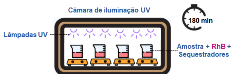
Figura 3.6 - Estudo dos mecanismos de reação com Rodamina B e sequestradores de OH • , e - e h + (Fonte: própria autoria).
