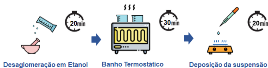
Figura 3.3 - Esquema de deposição do fotocatalisador cerâmico em um substrato de vidro (Fonte: própria autoria).
