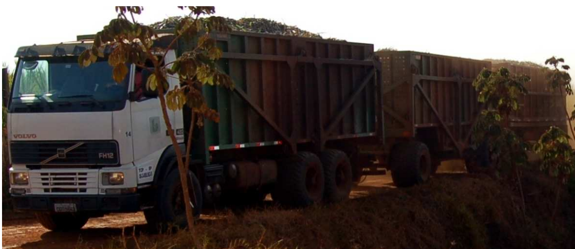
FIGURA 35. Caminhão e composição (caçamba) com pneus de alta flutuação são utilizados para evitar ou atenuar o processo de compactação no solo no momento da colheita e transporte. (Foto: André Ferreira).
