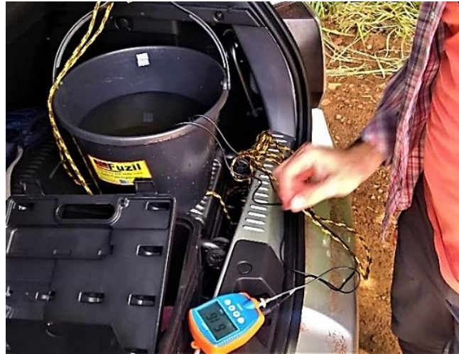
Figura 2: Equipamento utilizado em campo para medição do ORP. Fonte: PELEGRINI, 2021
