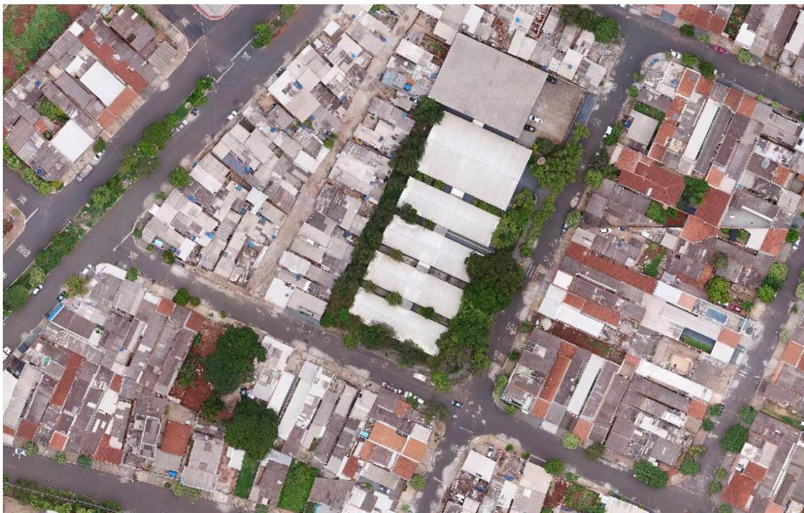
**Figura 2.10 – Imagem Ortoretificada gerada a partir do uso de nova ferramenta de coleta (Aeronave Remotamente Pilotada) para reconstrução e atualização de base cartográfica municipal.**
