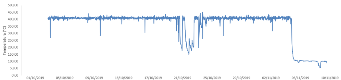
Figura 33 – Monitoramento da temperatura do vapor superaquecido na saída da caldeira a montante do trecho de tubulação analisado por este trabalho.
