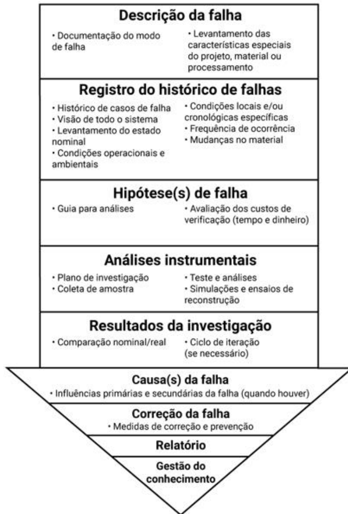
Figura 19 – Fluxograma de análise de falha definido pela VDI 3822.
