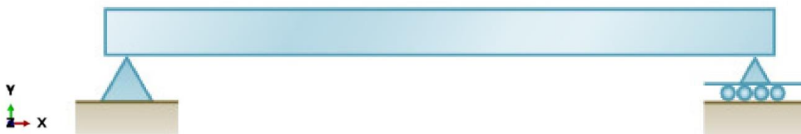
Figura 15 – Viga simplesmente apoiada no plano “xy”.
