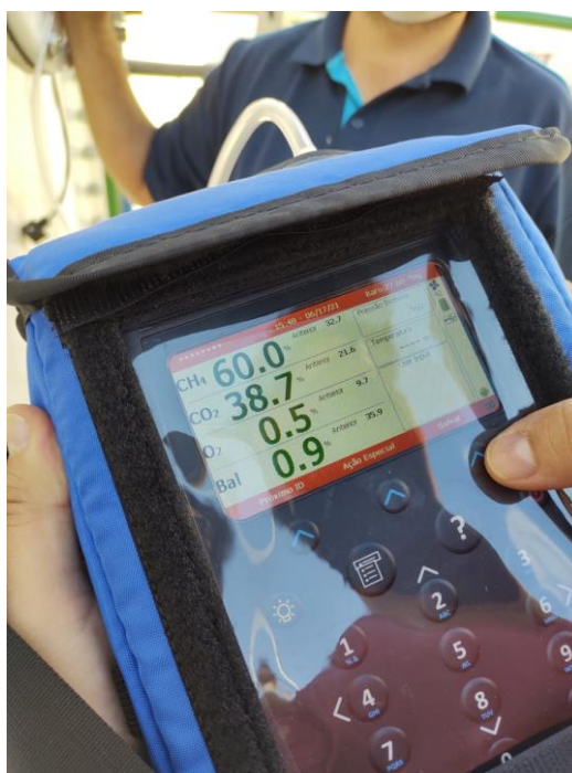
Figura 3.3.4 – Análise do biogás através de um analisador portátil
