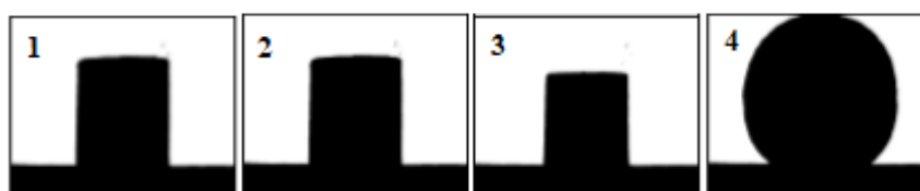
Figura 5.10 - Ensaio de microscopia de aquecimento para amostras em pó dos compósitos em estudo; Padrão de imagem para os compósitos em estudo.
