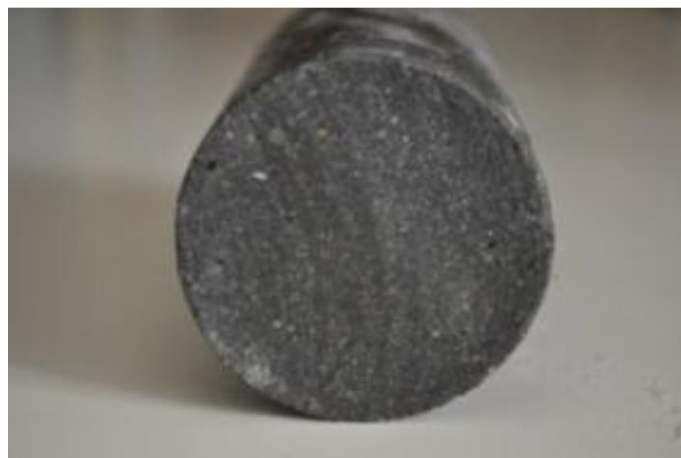
Figura 2.30 – Aspecto da seção do corpo de prova de CUAD rompido e retificado
