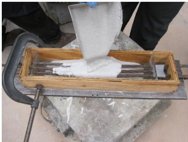
Figura 3.17 - Moldagem do bloco de CUAD com incorporação de cabos de protensão
