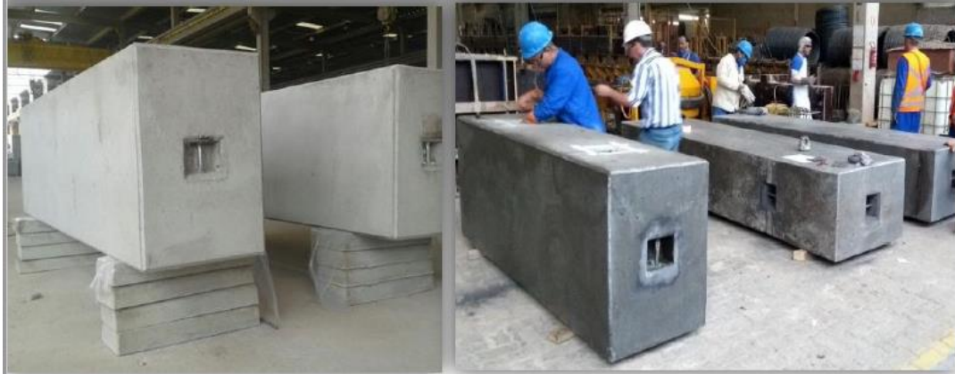
Figura 2.19 – Blocos de CUAD produzidos para o Projeto Sirius
