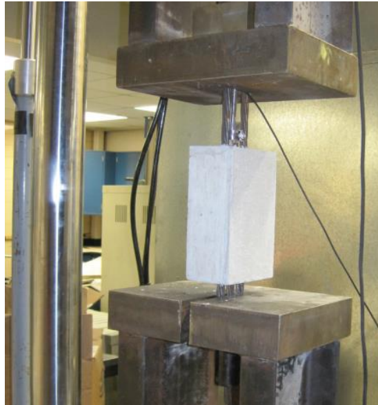
Figura 3.18 - Ensaio de comprimento de emenda de cabos de protensão no CUAD
