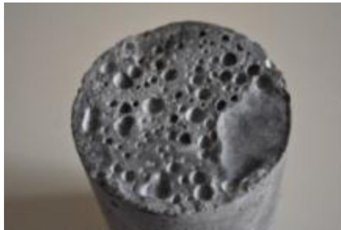
Figura 2.29 – Formação de bolhas no topo do corpo de prova de CUAD
