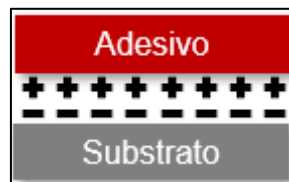
Figura 6 - Representação esquemática da adesão eletrostática.
