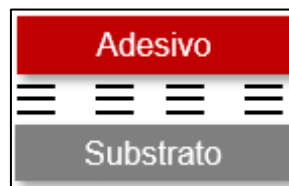
Figura 7 - Representação esquemática de adesão por adsorção.
