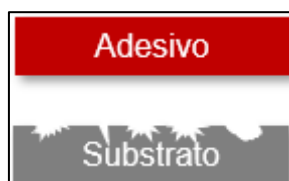
Figura 5 - Representação esquemática por adesão mecânica.
