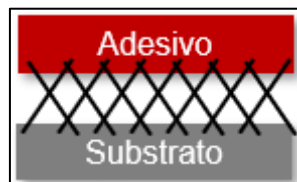
Figura 8 - Representação esquemática da adesão por interdifusão.
