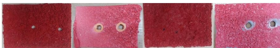
Figura 13 - Corpos de prova incrustados.
