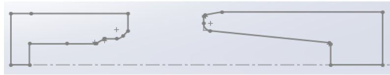
Figura 31 - Segundo estágio de forjamento
