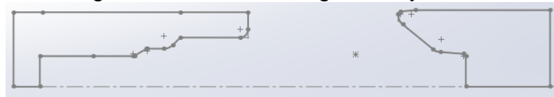
Figura 32 - Terceiro estágio de forjamento
