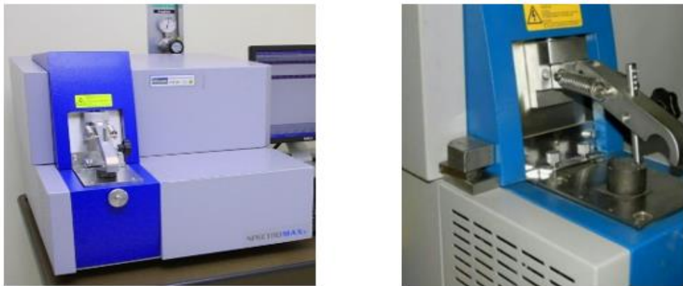
Figura 3.6 – Espectrômetro SPECTROMAX (à esquerda) e detalhe do suporte da amostra (à direita) [51].
