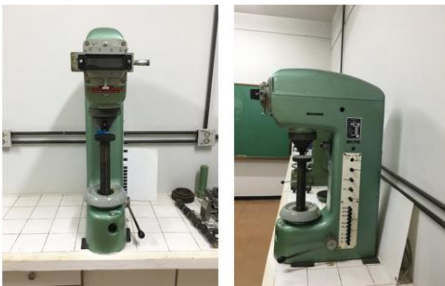
Figura 3.8 – Durômetro modelo Heckert HPO250. A esquerda (vista frontal) e a direita (vista lateral). Fonte: Próprio autor.
