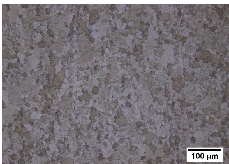
Figura 4.6 – Microestrutura do aço inoxidável 410 com ataque por reagente Villela. Fonte: Próprio autor.
