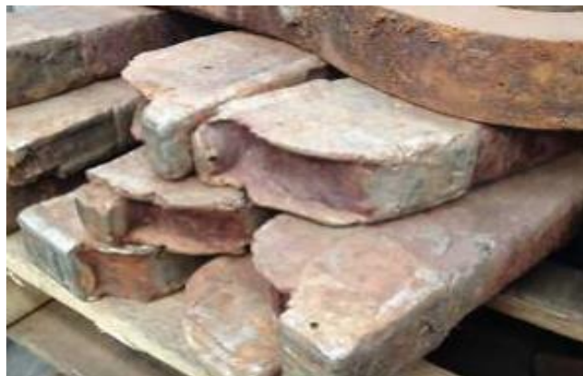
Figura 2.7 – Desgaste típico nos vértices dos martelos convencionais (largura da peça entre 130 e 170 mm e espessura de 50 e 70 mm) [41].
