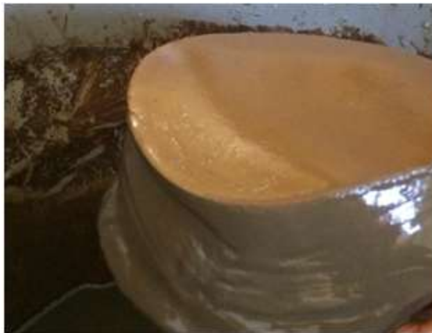
Figura 5.23 - Massa de lodo retida nos leitos após os desaguamentos por LD
