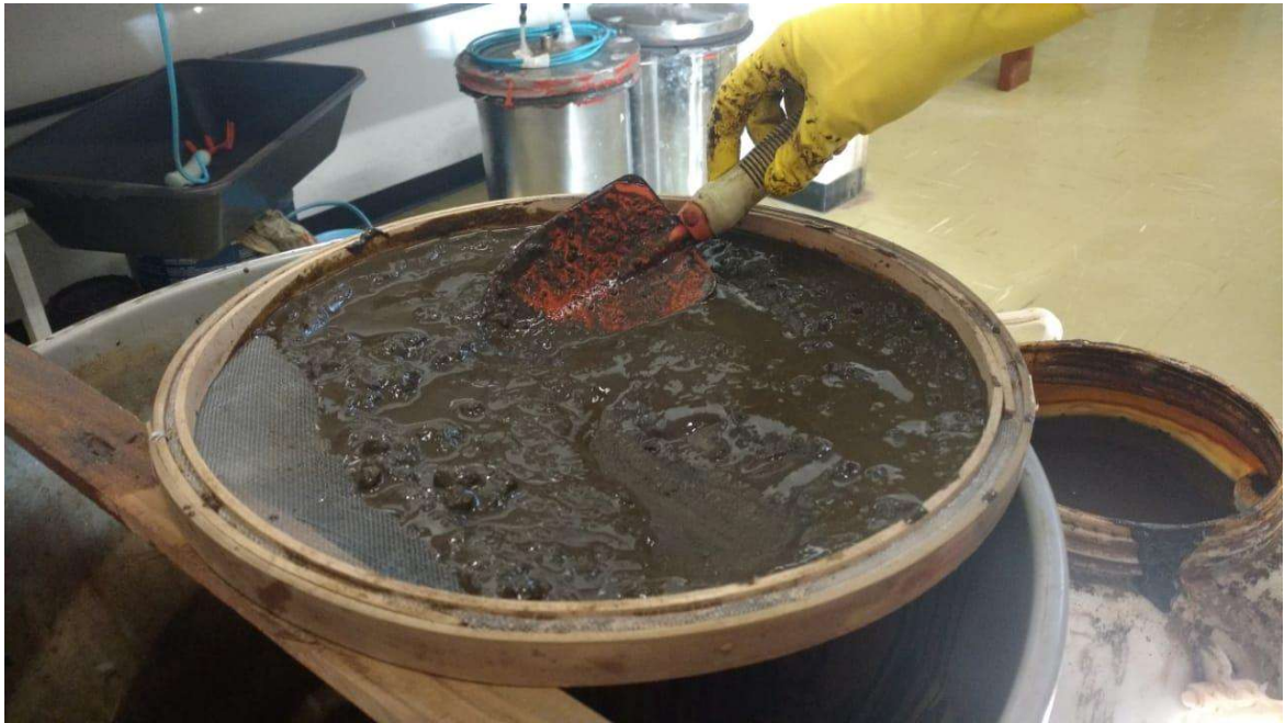
Figura 4.5 - Peneiramento do lodo bruto com %ST em torno de 9,0%.
