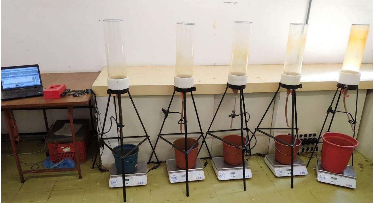
Figura 4.2 - Foto do Sistema de desaguamento de lodo em Leito de Drenagem (LD) utilizado nesta pesquisa
