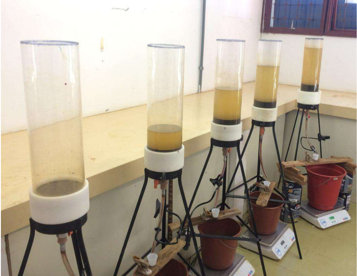
Figura 5.1 - Fotografia de um dos ensaios realizados, variando a altura da camada de lodo aplicada
