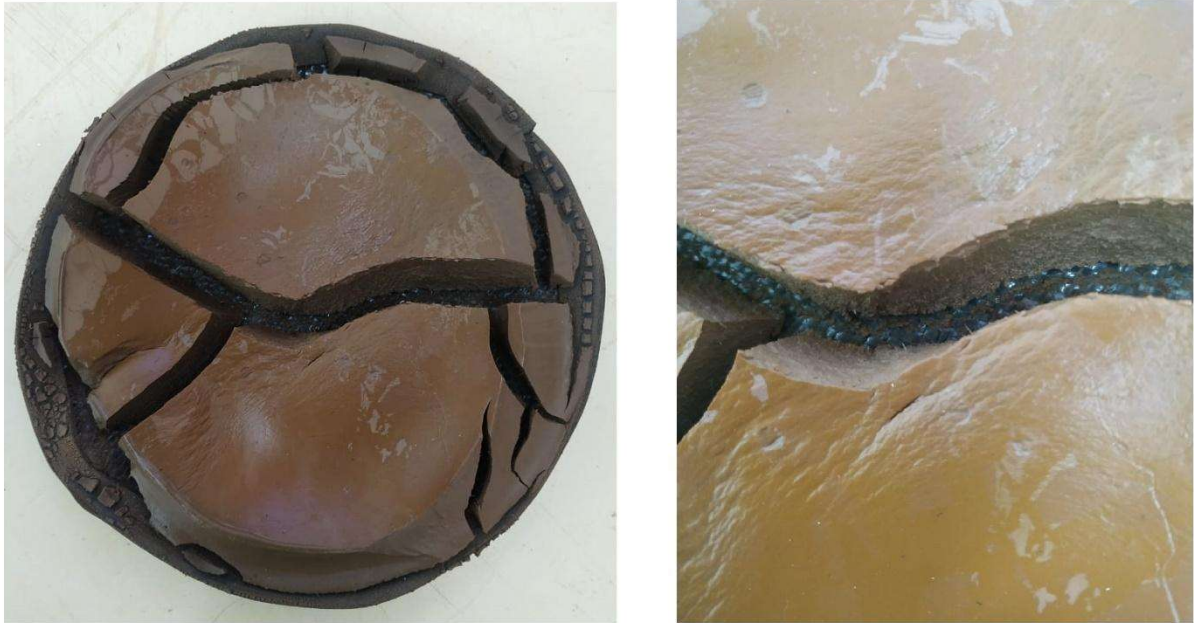
Figura 4.8 - Retração do lodo antes da retirada das amostras dos geotêxteis para realização dos ensaios MEV/EDS
