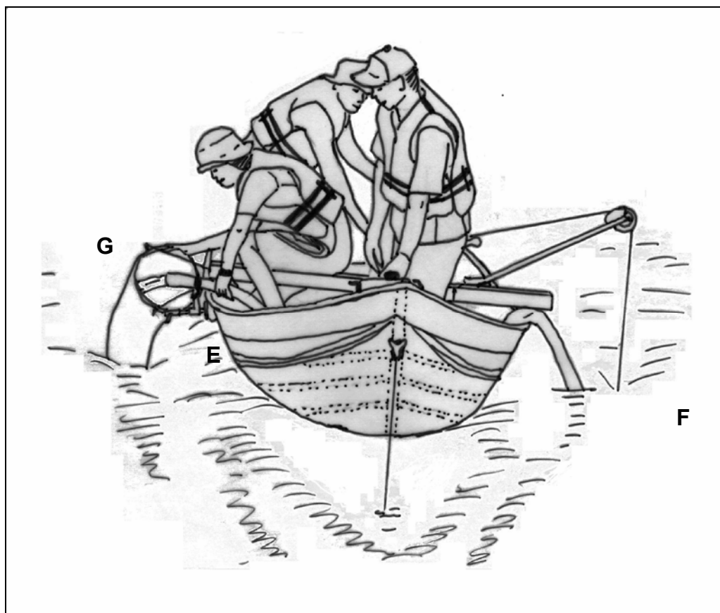
Figura 3. Procedimento de coleta. (E) ligar a bomba e a água sai da mangueira; (F) abaixar o amostrador com o guincho e (G) posicionar a rede coletora.
