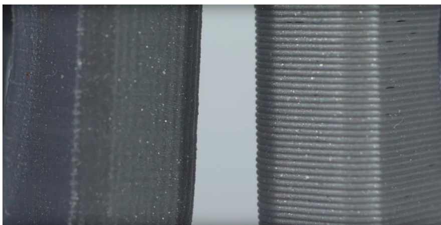
Figura 7 - Diferentes alturas de camadas de impressão
