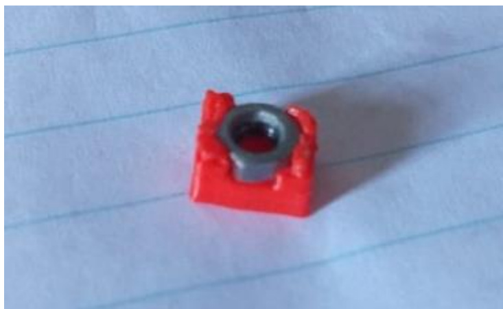
Figura 12 - Adaptador de porca do padrão imperial para o padrão métrico
