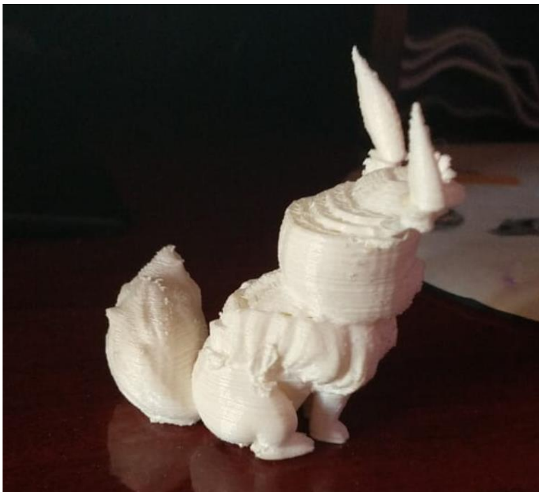
Figura 19 - Peça com deslocamento de camadas
