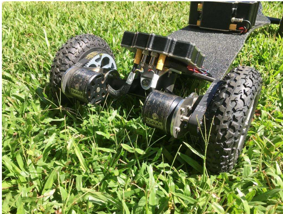
Figura 12 – Unidade propulsora do skate utilizado neste trabalho
