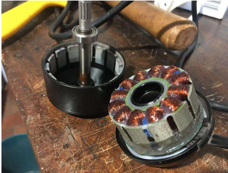
Figura 2 – Interior de um motor sem escovas
