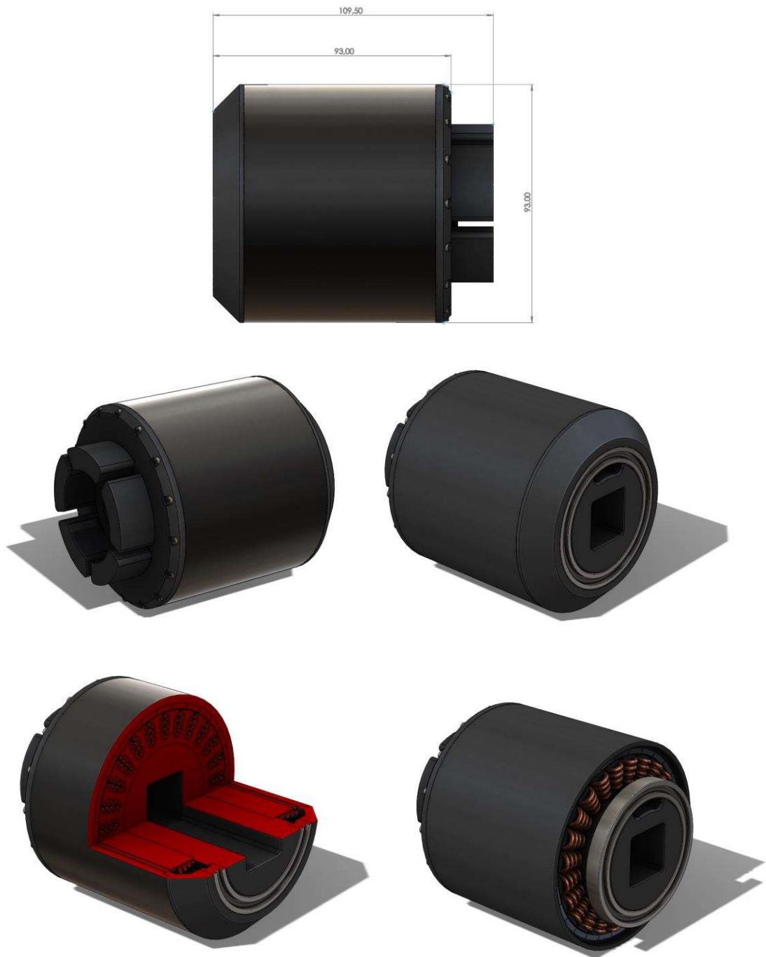
Figura 36 a 39 – Modelo em CAD do motor 80-28-E_3
