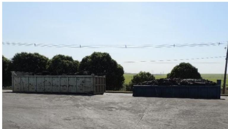
**Figura 4.5:** Material de descarte (areia queimada, com resina e sucata) referente ao que não se consegue reutilizar como matéria-prima, em container a ser transportado para o aterro industrial.
