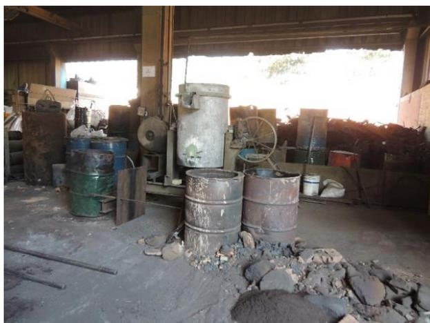
**Figura 4.10:** Deposição de areia e presença de poeira industrial no chão da fábrica, próximo ao armazenamento de sucata e utensílios. Notar o galpão bem aberto e ventilado.
