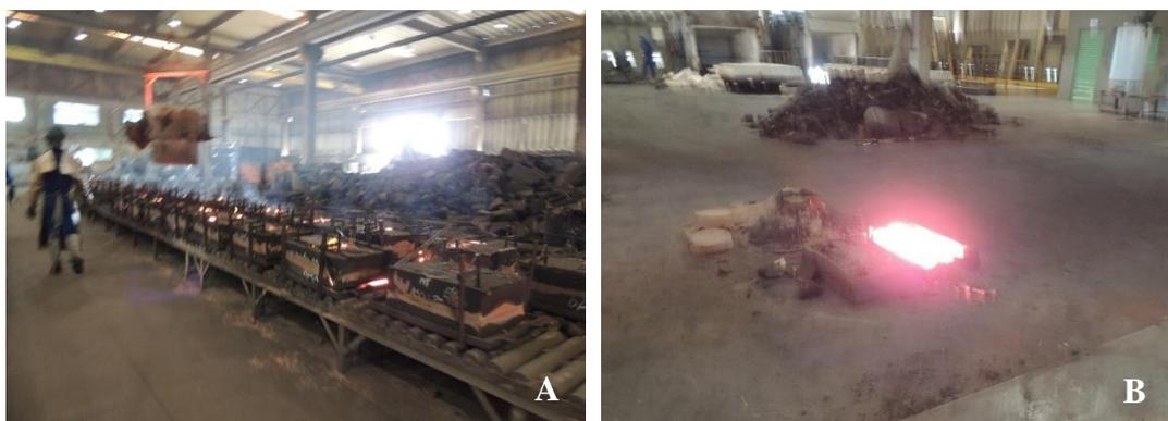
**Figura 4.11:** Falta de delimitação de áreas perigosas. Em **A**: despejamento do material fundido nos moldes de areia; e **B**: peça incandescente em esfriamento livre no chão do barracão de produção.
