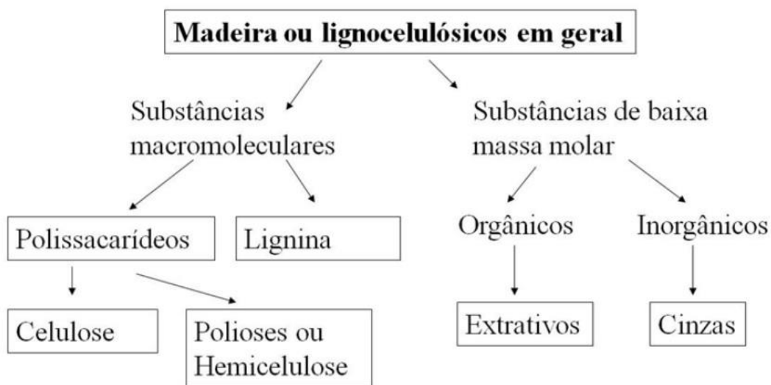
Figura 4: Constituição básica da fibra vegetal esquematizada.
