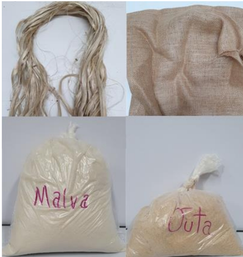
Figura 19: Fibras de malva e juta antes e depois de passarem pelo moinho de facas.
