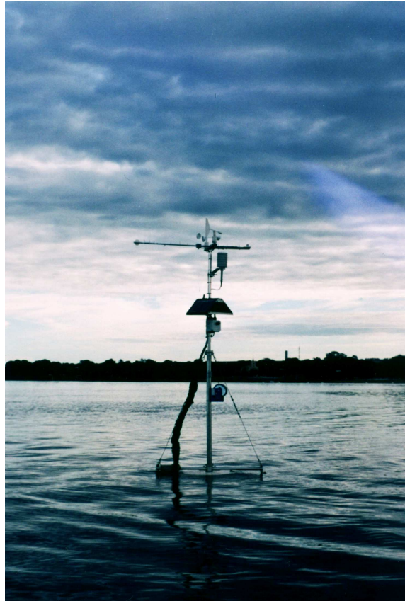
Figura 3: Ilustração da estação meteorológica no reservatório do Lobo. A cadeia de termístores foi instalada conjuntamente na coluna d'água.
