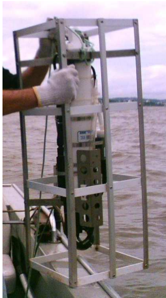
Figura 5: Ilustração da sonda oceanográfica de alta performance (CTD).
