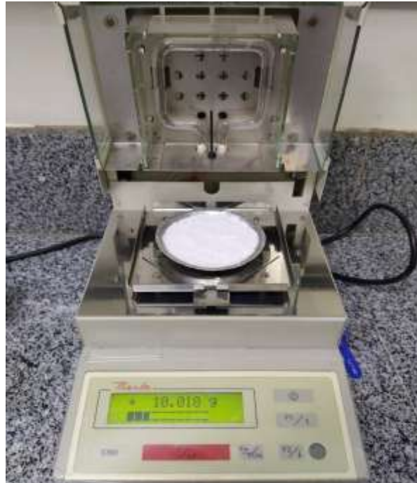
Figura 5.3. Medidor de umidade com amostra de tapioca.
