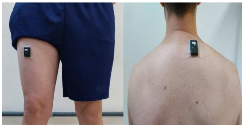
Figura 1 - Local de colocação dos sensores.
