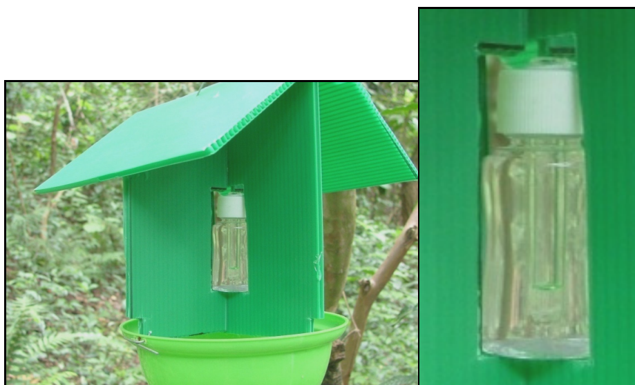
Figura 10 - A) armadilha modelo ESALQ-84. B) Isca de vidro com conta-gotas embutido na tampa, onde o etanol é exalado.
