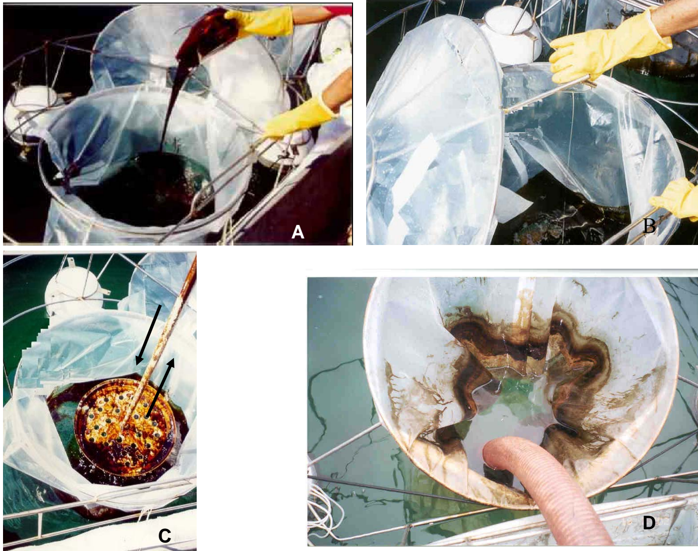
Figura 6: Principais etapas da simulação de derrame de petróleo na praia de Itaorna, Angra dos Reis, RJ, entre 19 de junho e 13 de julho de 2002. A – lançamento do petróleo; B – lançamento do dispersante; C – mistura com movimentos verticais lentos; D – recolhimento a vácuo do material no interior do mesocosmo para descarte.
