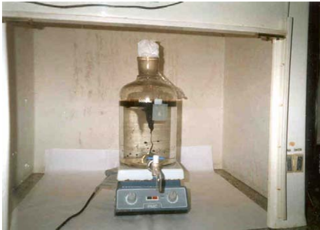
Figura 8: Preparo das soluções para os testes de toxicidade com petróleo e com a mistura do petróleo e dispersante com as microalgas Tetraselmis chuii e Skeletonema costatum . A – Preparo da fração solúvel do óleo em água do mar (FSA); B – Preparo da fração dispersa do óleo em água do mar (FDA).
