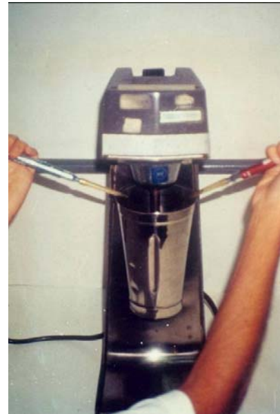
Figura 8: Preparo das soluções para os testes de toxicidade com petróleo e com a mistura do petróleo e dispersante com as microalgas Tetraselmis chuii e Skeletonema costatum . A – Preparo da fração solúvel do óleo em água do mar (FSA); B – Preparo da fração dispersa do óleo em água do mar (FDA).
