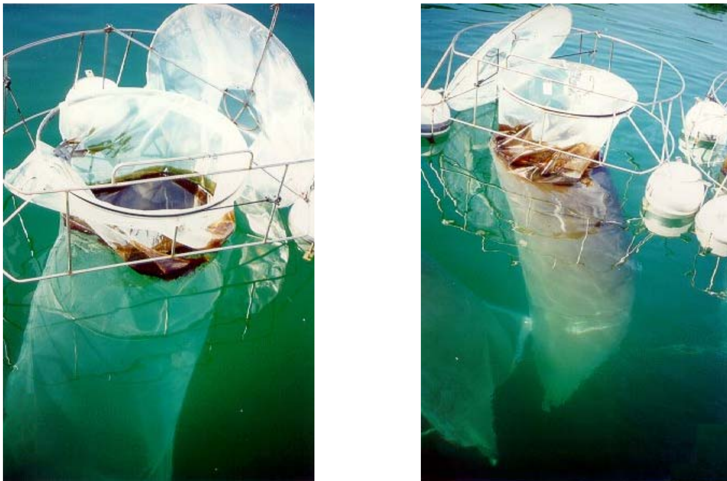
Figura 7: Vista da coluna d'água no interior dos mesocosmos após a simulação de derrame de petróleo na praia de Itaorna, Angra dos Reis, em 19 de junho de 2002. A – Simulação com petróleo (FMDA); B – Simulação com petróleo e dispersante (FQDA).
