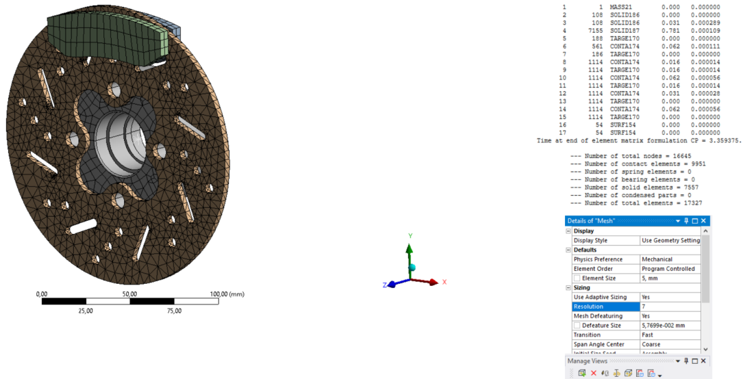
Figura 53 – Características da malha gerada na análise do disco de freio dianteiro do veículo (Autor).
