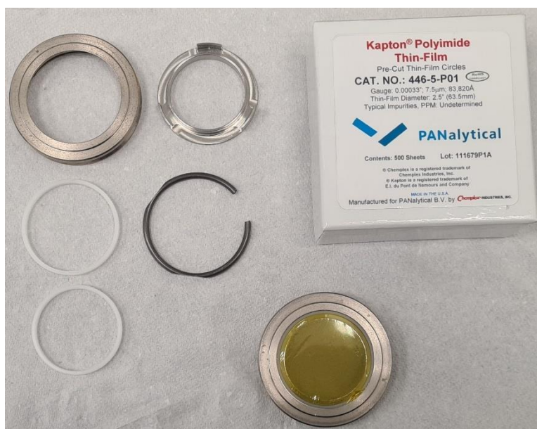
Figura 4.3 – Conjunto de preparação de amostras para modo transmissão.
