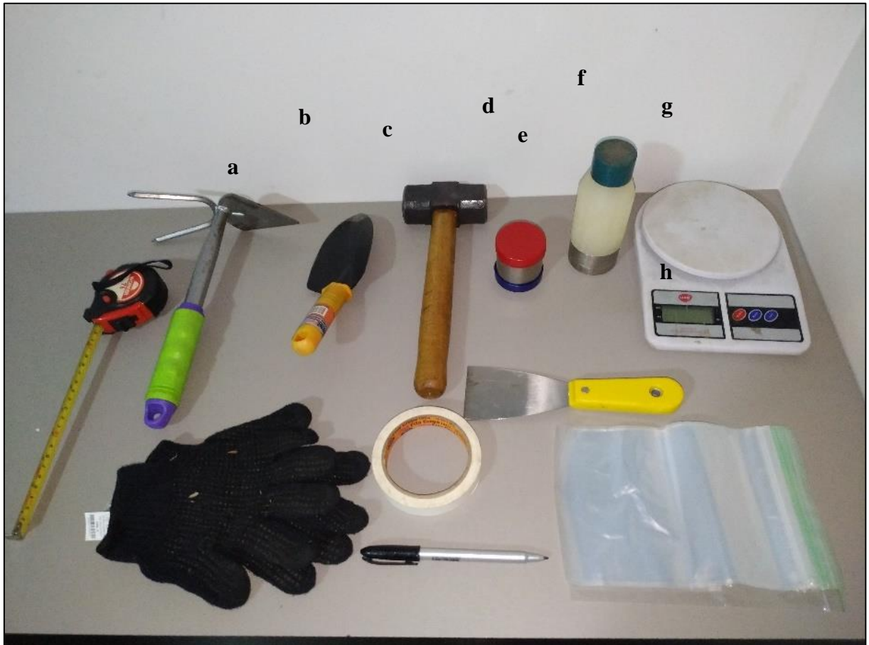
Figura 5.7: Materiais utilizados na coleta de solos nas veredas da APA Rio Pandeiros. a) Trena; b) enxada; c) pá; d) marreta; e) anel volumétrico 100cm 3 ; f) trado castelinho; g) balança; h) saco plástico. Foto: Lívia Caroline César Dias – set/2019
