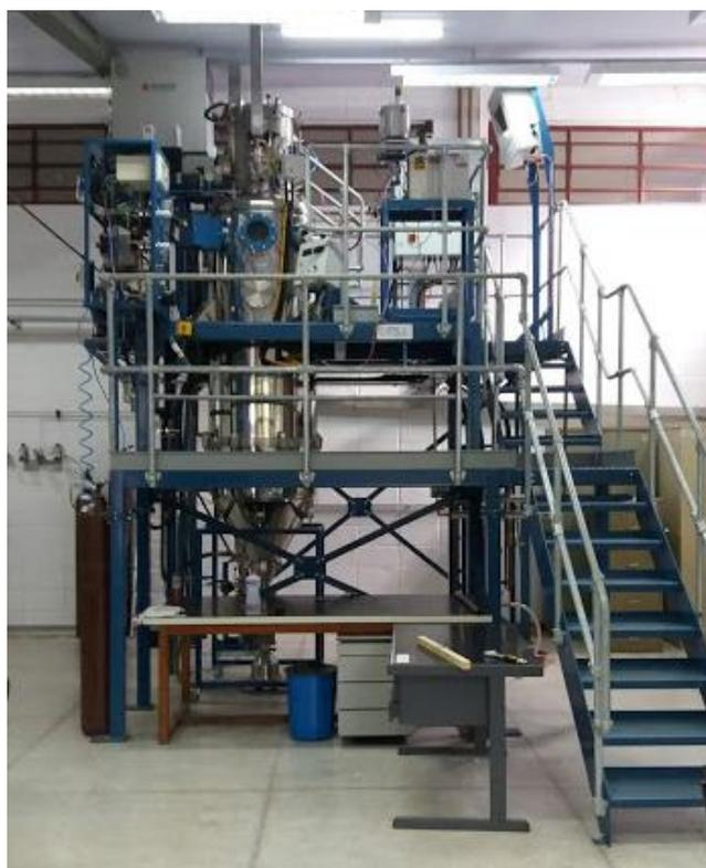
**Figura 3.3** - Imagem do atomizador, localizado no Laboratório de Atomização e Revestimento do DEMa/UFSCar.
