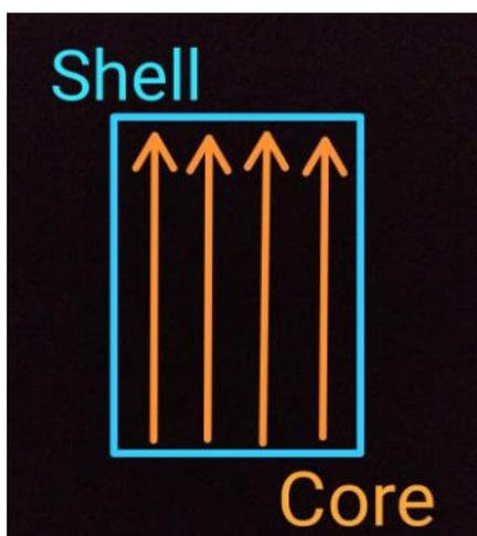
**Figura 3.4** - Desenho esquemático da estratégia de varredura Core-Shell.
