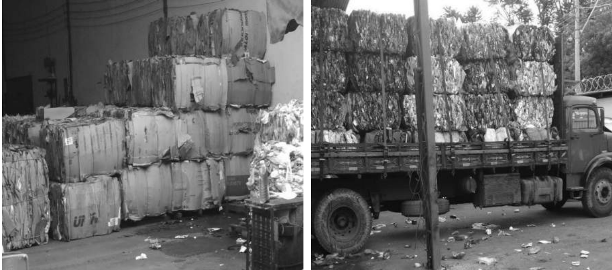
Figuras 25 e 26 – Fardo de papelão prensado e caminhão carregado para venda dos materiais.
