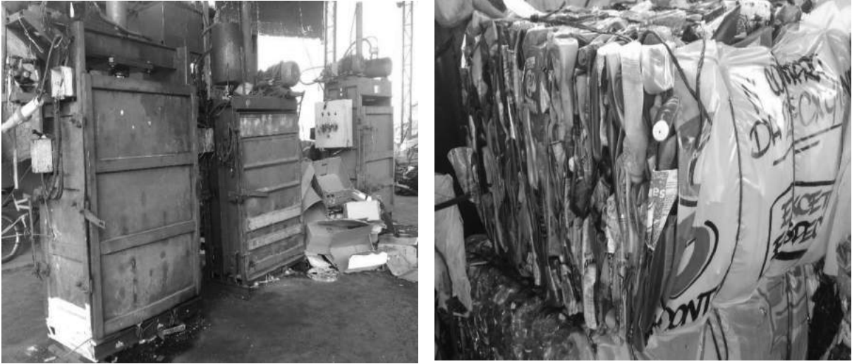
Figuras 19 e 20– Imagens das Prensas e material PEAD colorido já prensado
