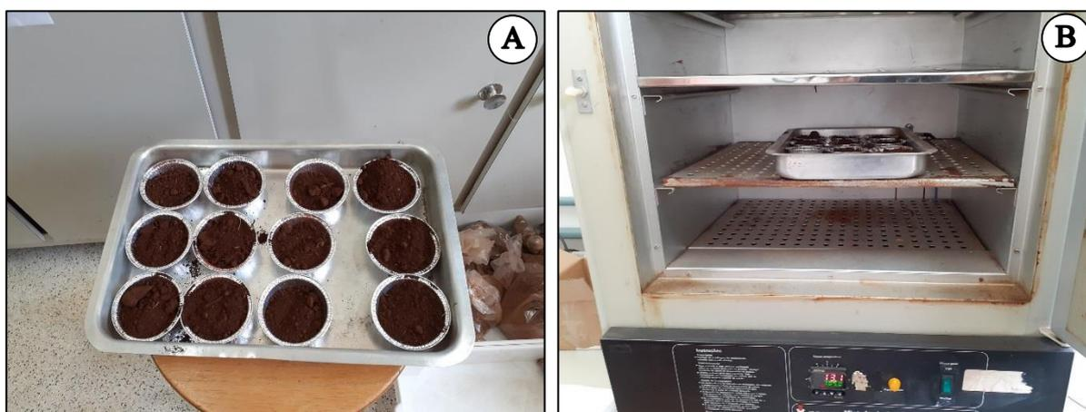
**Figura 8.** (A) Massa de solo úmido separadas por parcelas. (B) Amostras na estufa a  $105^{\circ}\text{C}$ .
