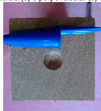
Figura 11 - Ensaios de dureza Janka nas direções paralela (a) e perpendicular (b) às fibras.
