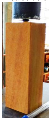
Figura 11 - Ensaios de dureza Janka nas direções paralela (a) e perpendicular (b) às fibras.
