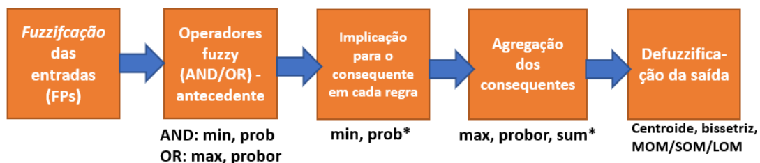
Figura 3.9. Estrutura de um Sistema de Inferência Fuzzy (FIS). * = métodos usados em sistemas do tipo Takagi-Sugeno.
