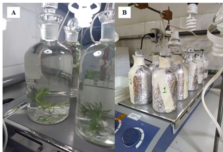
Figura 3: Tratamentos na presença de glitter. (A) frascos submetidos a radiação com macrófitas na presença do glitter e (B) frascos isolados da radiação com macrófitas com glitter. Fonte: Arquivo pessoal (2020).
