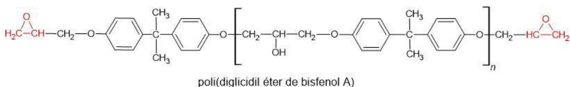
Figura 2.5 – Estrutura química do poli(diglicidil éter do bisfenol-A) a partir do diglicidil éter do bisfenol-A, bisfenol A e epícloridrina [Adaptado de 21 apud.22].
