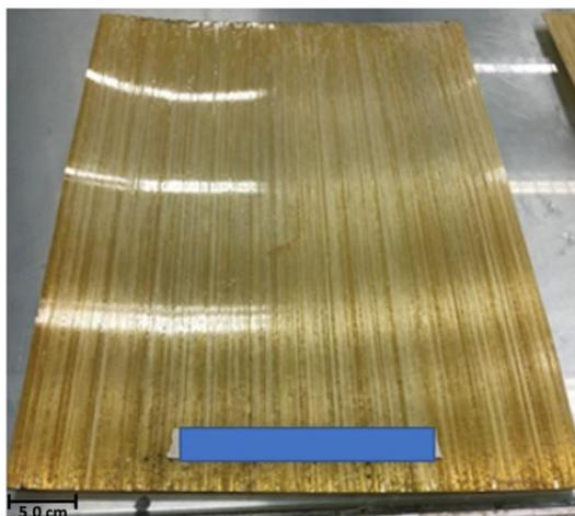
Figura 3.4 – Exemplo de uma das placas do compósito epóxi/fibra de vidro fabricadas por enrolamento filamentar.
