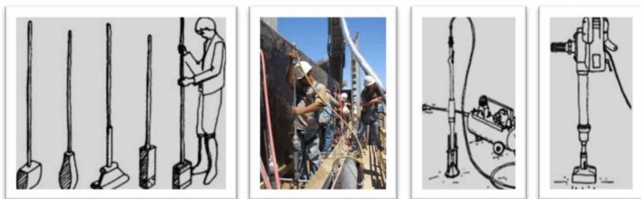
Figura 5 - Evolução dos compactadores, de manuais à pneumáticos. Fonte: Veraldo (2015), adaptado de Minke (2001)
